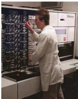
Der SMAC misst mehrere Parameter im „Profil“ parallel aus nur einer Probe, 1984.
